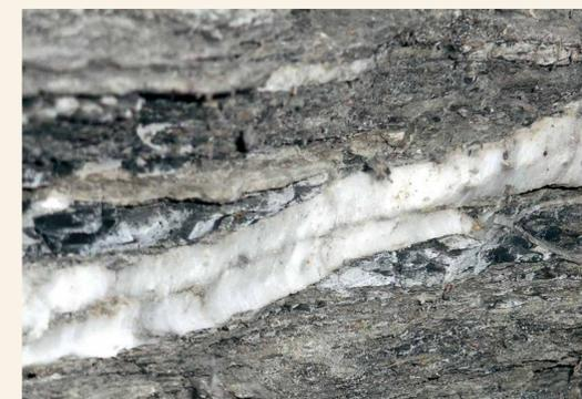
Fasergips ist kristallin. Er entsteht, wenn gipshaltiges Wasser durch Gesteinsklüfte rieselt.
